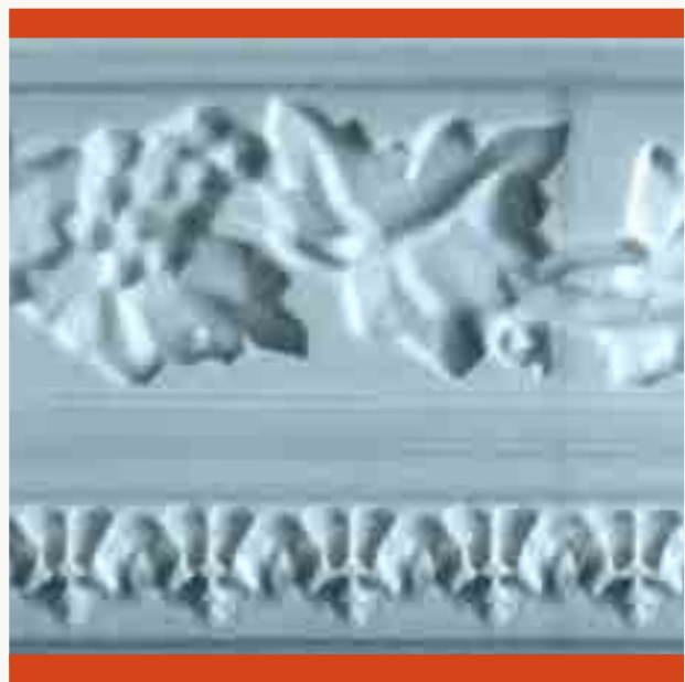
Immagine del calco siliconico dell'elemento con i tori, ottenuto dal modello stampato a polvere di gesso
