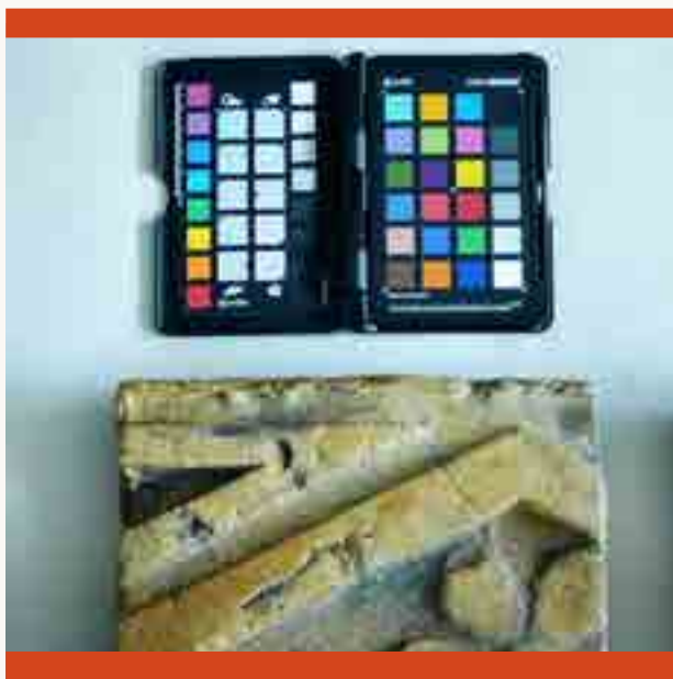
Immagini delle campionature di varie finiture cromatiche, realizzate in scala reale su un dettaglio significativo del modello
